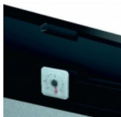
Thermomètre au niveau de la zone de chargement pour un contrôle rapide et permanent de la température
